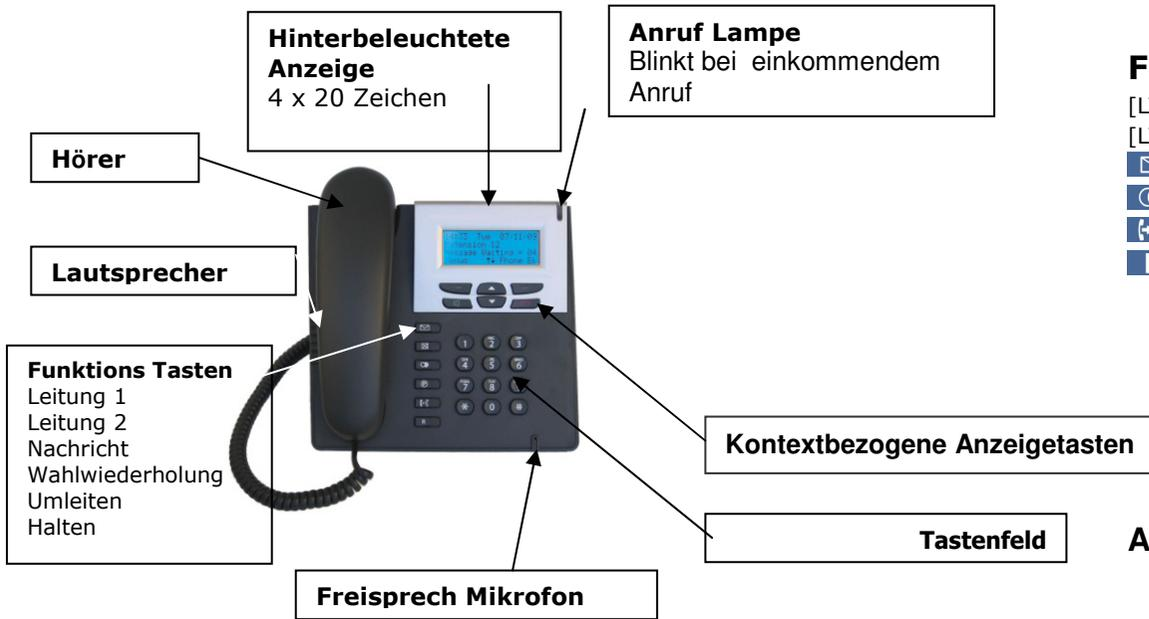
Das Operafone IP Professional ist ein benutzerfreundliches Voice Over IP Telefon, welches über ein IP LAN oder WAN an die Opera Anlage angeschlossen werden kann.
